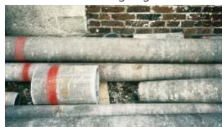
Canalisation en amiante-ciment
